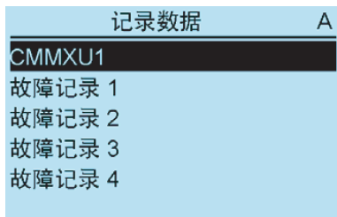
图51: 监视故障记录
